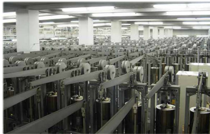
【数百台が居並ぶ「クリープ試験機」:長い年月を超え、同じ温度で金属を引っ張り続けるクリープ試験機の列には、どこか厳かな雰囲気漂い、まるで千手観音立像が千体並ぶことで有名な三十三間堂のようにも見えることから、この部屋を「クリープ試験機 三十三間堂」と呼ぶ人もいます。】
